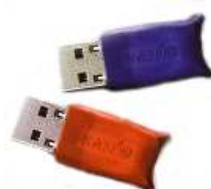
Figura 10: Llaves HASP por USB utilizadas para el registro del software.
